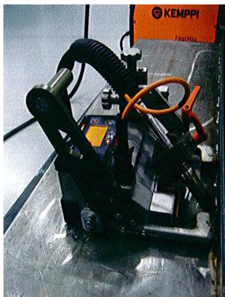
Obr. 6. Mag Trac F 61 je magnetický svařovací vozík na kolečkách.
