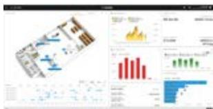
Die Gesamtübersicht von WeldEye ArcVision fasst die Schweißproduktion zusammen. Es zeigt alle Schweißmaschinen auf dem Grundriss des Einsatzortes an und veranschaulicht die Nutzungs- und Verbrauchsdaten der gesamten Produktion in übersichtlichen Grafiken.
