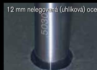
12 mm otvor vyřezaný pomocí technologie True Hole
