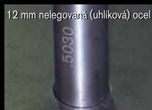
12 mm otvor vyřezaný pomocí technologie True Hole
