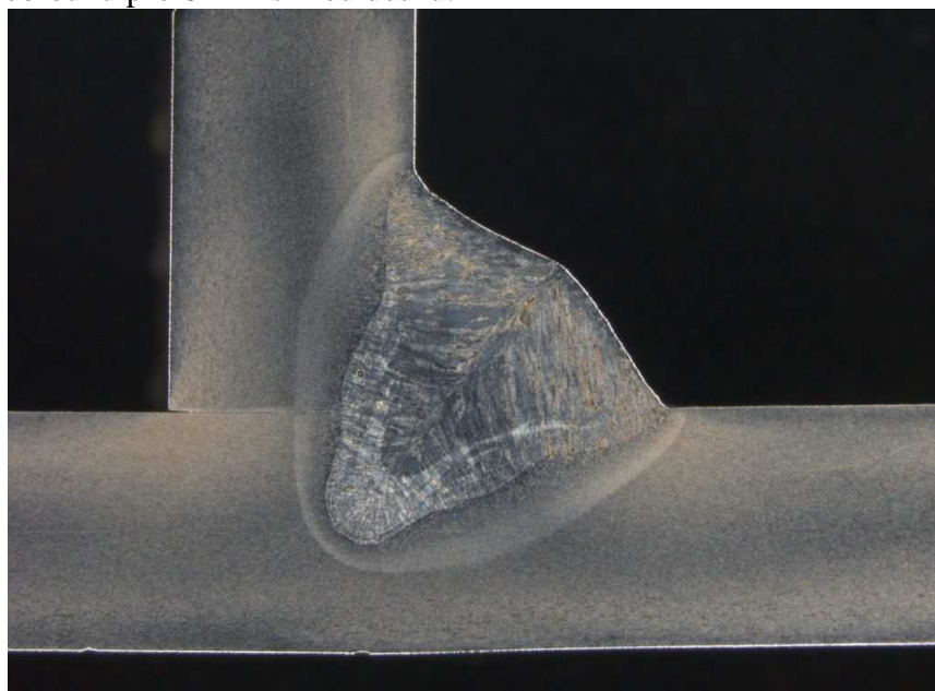
Obrázek 6. Horizontálně-vertikální svar pomocí hodnot WiseSteel procesního stříkacího oblouku pro 6 mm silnou desku.
